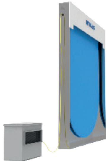
Ce clapet est équipé d'un capteur et d'un enregistreur évènementiel. Il est pourvu d'un inclinomètre et d'un câble étanche placé sur le corps du clapet. Chaque mouvement d'ouverture est enregistré et transformé en débit. Communication à distance par système Sofrel, Inginus ou équivalent.
